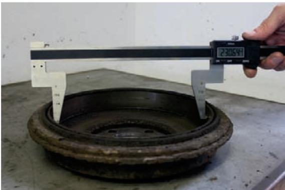
Der digitale ATE Bremstrommel-Messschieber ist ein unentbehrliches Instrument, um den Verschleißzustand von Bremstrommeln präzise ermitteln zu können. Er ermöglicht das schnelle und einfache Messen des Bremstrommeldurchmessers bzw. des Verschleißmaßes.
