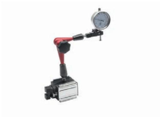
Der ATE Magnet-Messuhrhalter ermöglicht das schnelle und sichere Befestigen der ATE Messuhr für das Messen des Plan- und Rundlaufs von Radnaben und Bremsscheiben. Er verfügt über 70 Stahlzungen, die sich optimal jeder Kontur anpassen. Dadurch kann der ATE Magnet-Messuhrhalter auch an unebenen Flächen, etwa dem Federbein, angesetzt werden. Der extra starke Magnet bringt eine Haltekraft von 60N auf, so dass die Messuhr in allen Situationen sicher und verwicklungsfrei befestigt werden kann.
