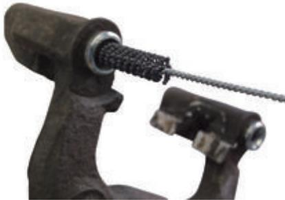
Zur Führung von Faustsätteln "LUCAS" werden geschmierte Führungsbolzen verwendet. Diese werden mit Faltenbälgen abgedichtet. Bei beschädigten Faltenbälgen korrodieren die Führungsbüchsen im Bremsattelträger. In der Folge kommt es zum Schwergang der Sattelführung und zu weiteren Bremsenproblemen.
