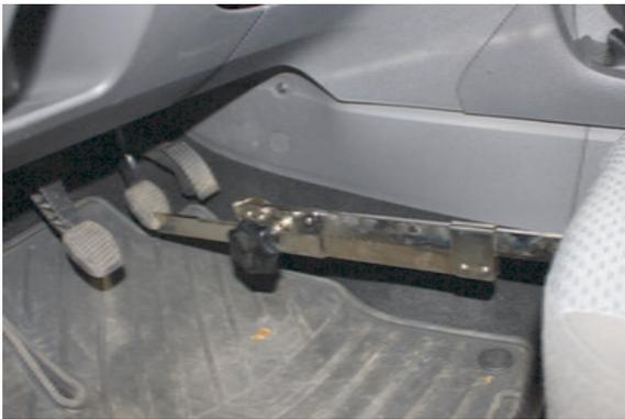
Mit dem ATE Pedalfeststeller kann das Bremspedal belastet und in der gewünschten Position fixiert werden. Dadurch kann ein konstanter Pedaldruck über längere Zeit aufrecht gehalten werden.
