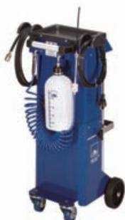
Der Bremsflüssigkeitswechsel und das Füllen oder Entlüften der Bremsanlagen aktueller Fahrzeuge mit ihren elektronischen Bremssystemen, aber auch die niedrigviskosen Bremsflüssigkeiten erfordern moderne Service-Geräte.
