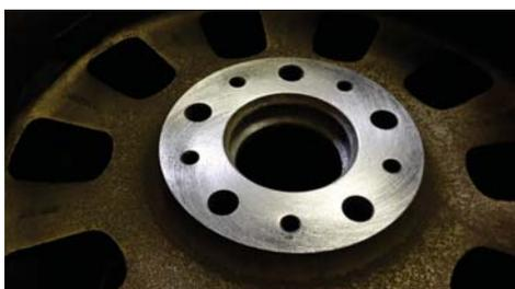
Das ATE Felgenflansch-Reinigungsset ist ein ideales Werkzeug für das schnelle, sichere und preiswerte reinigen der Felgenanlagefläche. Vor der Montage der Felge ist es ratsam die Anlagefläche der Felge zur Bremsscheibe zu reinigen. Nur so können die engen Toleranzen zwischen Felge und Bremsscheibe eingehalten werden.
