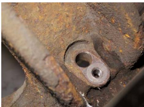
Vor dem Einbau eines neuen ABS-Raddrehzahlsensors muss dessen Aufnahmebohrung gründlich gereinigt und wieder auf Nennmaß gebracht werden. Die ATE Reibahle ist dafür das ideale Werkzeug.
