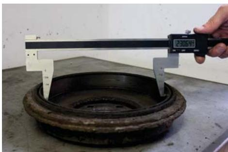
Der digitale ATE Bremstrommel-Messschieber ist ein unentbehrliches Instrument, um den Verschleißzustand von Bremstrommeln präzise ermitteln zu können. Er ermöglicht das schnelle und einfache Messen des Bremstrommeldurchmessers bzw. des Verschleißmaßes. Der Messbereich beträgt 400 mm. Die Ausführung der Messschenkel gestattet das exakte Messen trotz Grat in der Bremstrommel.
