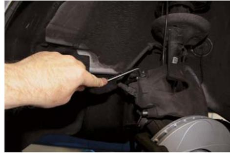
Der ATE Spezial-Entlüfterschlüssel-Satz besteht aus speziell gekröpften Ringschlüsseln. Dank langer und kurzer Kröpfung ermöglichen sie das bequeme Öffnen und Schließen der Entlüftungsventile ohne Raddemontage. Die Köpfe der ATE Spezial-Entlüfterschlüssel sind als Sechskant ausgeformt. Das gewährleistet ein sicheres Betätigen der Entlüftungsventile, ohne diese zu beschädigen.
