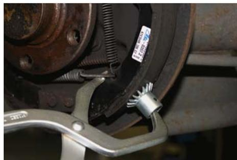
Die ATE Bremsfederzange (LKW) ist ein unverzichtbares Werkzeug für die sichere und beschädigungsfreie Montage und Demontage von Bremsbacken-Rückzugfedern. Sie verfügt über einen gelenkigen, mit scharfen Krallen versehenen Stützteller, der sich auf allen Bremsbelagoberflächen abrutschfrei abstützt. Der speziell geformte Haken gestattet das sichere Einhängen der Feder. Damit ist ein bequemer und beschädigungsfreier Ein- bzw. Ausbau der Bremsbackenrückzugfedern gewährleistet.
