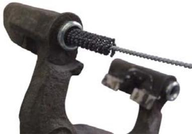
Zur Führung von Faustsätteln "LUCAS" werden geschmierte Führungsbolzen verwendet. Diese werden mit Faltenbälgen abgedichtet. Bei beschädigten Faltenbälgen korrodieren die Führungsbüchsen im Bremssattelträger. In der Folge kommt es zum Schwergang der Sattelführung und zu weiteren Bremsenproblemen.
