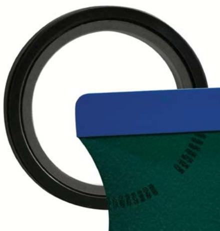
Active Raddrehzahlsensoren arbeiten mit empfindlichen magnetischen Sensorrädern, die in den Gummidichtring des Radlagers integriert sind. Da die Funktion magnetischer Sensorräder optisch nicht beurteilt werden kann, ist die ATE Testerkarte ein unentbehrliches Hilfsmittel zum Prüfen der Radlager vor der Montage, zum Feststellen der Einbaurichtung des Radlagers und zur Fehlersuche bei Radsignalstörungen.
