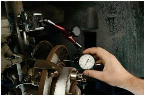
Der ATE Magnet-Messuhrhalter ermöglicht das schnelle und sichere Befestigen der ATE Messuhr für das Messen des Plan- und Rundlaufs von Radnaben und Bremsscheiben. Er verfügt über 70 Stahlzungen, die sich optimal jeder Kontur anpassen. Dadurch kann der ATE Magnet-Messuhrhalter auch an unebenen Flächen, etwa dem Federbein, angesetzt werden. Der extra starke Magnet bringt eine Haltekraft von 60N auf, so dass die Messuhr in allen Situationen sicher und verwacklungsfrei befestigt werden kann.
