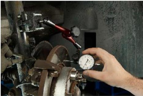
Die ATE Distanzscheiben ermöglichen das schnelle und sichere Befestigen der Bremsscheibe auf der Radnabe. Mittels der original Radschrauben oder Muttern bis M14 mit Kugel- oder Kegelfund wird die Bremsscheibe professionell auf der Nabe befestigt und für das Messen des Plan- und Rundlaufs vorbereitet.
