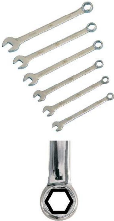
Der ATE Entlüfterschlüsselsatz besteht aus kombinierten Ring-/Gabelschlüsseln und eignet sich hervorragend für das Öffnen und Schließen aller gängigen Entlüftungsventile beim Bremsflüssigkeits-wechsel oder Entlüften des Bremssystems. Die Ringschlüsselseite ist als Sechskant ausgeformt und um 10° abgewinkelt. Das gewährleistet ein bequemes und sicheres Betätigen der Entlüftungsventile, ohne diese zu beschädigen.
