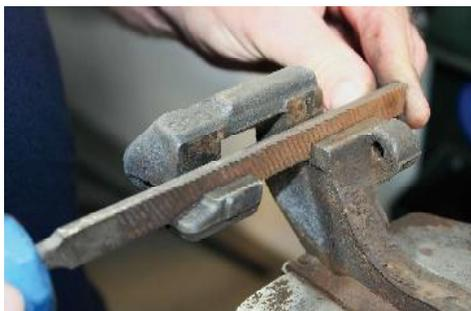
Vor dem Einbau neuer Bremsbeläge müssen die Belagführungsflächen an den Bremssätteln und -haltern metallisch blank gereinigt werden. Mit der ATE Bremssattel-Schachtfeile lassen sich alle Arten von Ablagerungen schnell und einfach entfernen. Der einseitige Hieb der ATE Bremssattel-Schachtfeile vermeidet das Beschädigen der Staubschutzkappen. Die groben Spezial-Zähne ermöglichen ein schnelles und sauberes Arbeiten.
