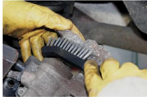
Vor dem Einbau neuer Bremsbeläge müssen die Belagführungsflächen an den Bremssätteln und -haltern metallisch blank gereinigt werden. Mit der ATE Spezial-Drahtbürste lassen sich Verunreinigungen mühelos entfernen.
