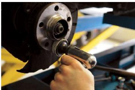
Das ATE Radnaben-Reinigungsset 4 ist ein ideales Werkzeug für das schnelle, sichere und preiswerte Reinigen von stark verschmutzten oder angerosteten Radnaben. Vor der Montage der Bremsscheibe muss die Anlagefläche der Radnabe metallisch blank gereinigt werden. Nur so können die Einbautoleranzen eingehalten und Bremsenrubbeln vermieden werden.
