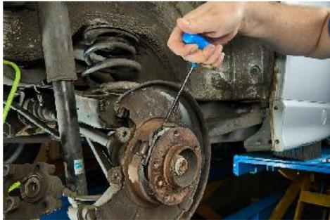
Der ATE Federhaken ist das ideale Werkzeug zur problemlosen Demontage und Montage von Bremsbelag-Haltefedern.
