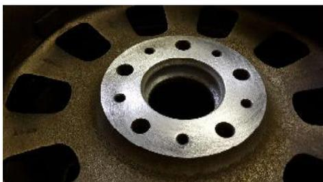
Das ATE Felgenflansch-Reinigungsset ist ein ideales Werkzeug für das schnelle, sichere und preiswerte reinigen der Felgenanlagefläche. Vor der Montage der Felge ist es ratsam die Anlagefläche der Felge zur Bremsscheibe zu reinigen. Nur so können die engen Toleranzen zwischen Felge und Bremsscheibe eingehalten werden.
