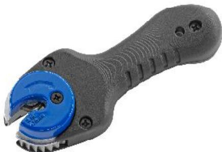
Der ATE Ratschen-Rohrabschneider ist ein ideales Werkzeug für das fachgerechte Abschneiden von Bremsrohren mit einem Durchmesser von 4,75 mm. Dank seiner kompakten Bauweise und der Ratschenfunktion kann er selbst bei beengten Platzverhältnissen auch direkt am Fahrzeug eingesetzt werden. Durch die automatische Nachstellfunktion entfällt das Nachspannen des Schneidrads beim Schneidvorgang. Durch zusätzliche Hebelwirkung aufgrund der Grifflänge ist nur ein geringer Kraftaufwand nötig.
