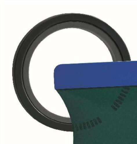
Aktive Raddrehzahlsensoren arbeiten mit empfindlichen magnetischen Sensorrädern, die in den Gummidichtring des Radlagers integriert sind. Da die Funktion magnetischer Sensorräder optisch nicht beurteilt werden kann, ist die ATE Testkarte ein unentbehrliches Hilfsmittel zum Prüfen der Radlager vor der Montage, zum Feststellen der Einbaurichtung des Radlagers und zur Fehlersuche bei Radsignalstörungen.
