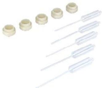
Für das Ermitteln des Bremsflüssigkeitssiedepunktes mit dem Bremsflüssigkeits-Testgerät ATE BFCS 300 muss eine Probe aus dem Ausgleichsbehälter entnommen werden. Dazu wird eine Einweg-Pipette und ein Einweg-Probenbecher benötigt. Die Pipetten verfügen über ein langes Entnahmeröhrchen, so dass auch ungünstig gelegene Ausgleichsbehälter bequem erreicht werden können.
