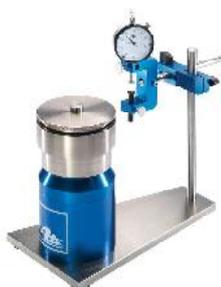
Die ATE Bremsscheibenmessvorrichtung ermöglicht das präzise Vermessen von ausgebauten Bremsscheiben bis zu einem Durchmesser von 360 mm auf Seitenschlag und Dickentoleranz.
