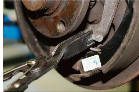
Die ATE Feststellbremsseil-Federzange ist ein sehr praktisches Hilfsmittel für das Einhängen des Feststellbremsseils an Trommelbremsen. Die flachen Backen ermöglichen das problemlose Zurückdrücken der Bremsseil-Rückzugfeder und das bequeme Einhängen des Seilendes in den Betätigungshebel. Schäden am Feststellbremsseil werden somit vermieden.
