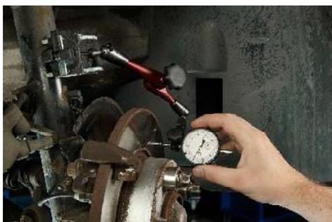
Der ATE Magnet-Messuhrhalter ermöglicht das schnelle und sichere Befestigen der ATE Messuhr für das Messen des Plan- und Rundlaufs von Radnaben und Bremscheiben. Er verfügt über 70 Stahlzungen, die sich optimal jeder Kontur anpassen. Dadurch kann der ATE Magnet-Messuhrhalter auch an unebenen Flächen, etwa dem Federbein, angesetzt werden. Der extra starke Magnet bringt eine Haltekraft von 60N auf, so dass die Messuhr in allen Situationen sicher und verwacklungsfrei befestigt werden kann.
